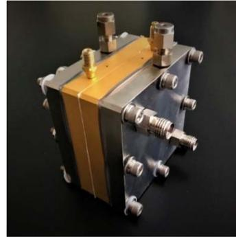
図 1 実際の CO<sub>2</sub> 電解還元セル
