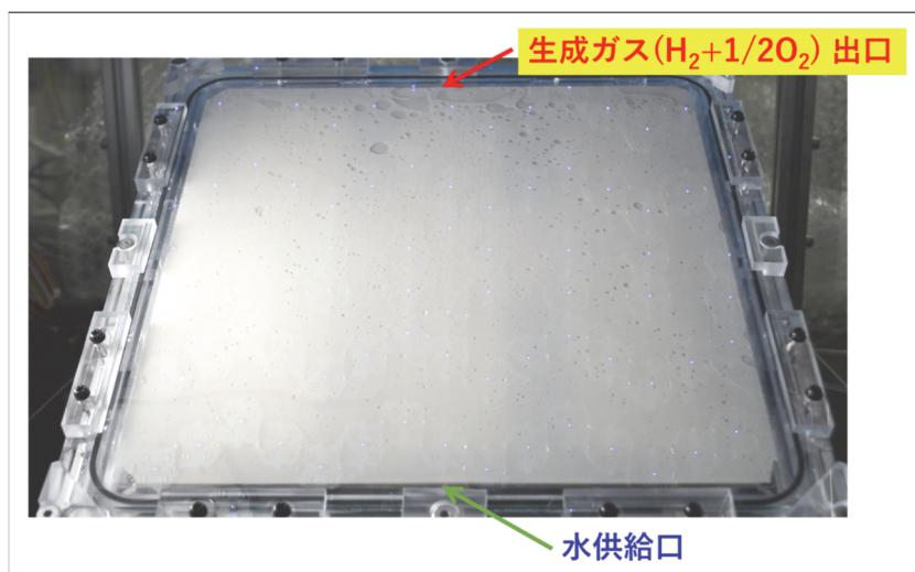
図6 光触媒シートを装着した水分解パネル
