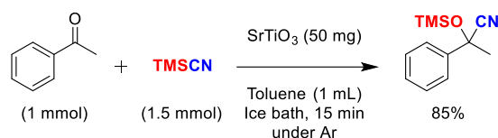
図 2. SrTiO 3 ナノ粒子を用いたシアノシリル化反応。
